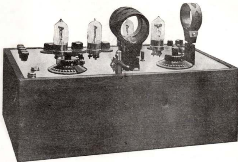
S 4 — 4-Lampes Radiomodtager med Detektor samt 1 Højfrekvens og 2 Lavfrekvens-Forstærkere.
